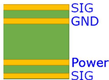
Figure 7 : Le stack-up classique SIG – GND – Power – SIG.
