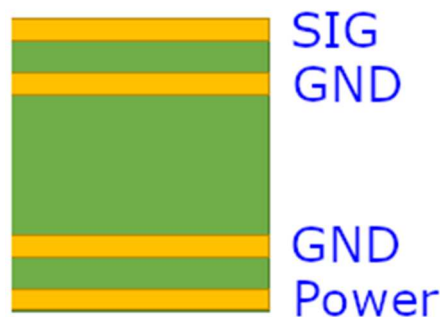
Figure 9 : Le stack-up SIG – GND – GND – Power du RDAM.
